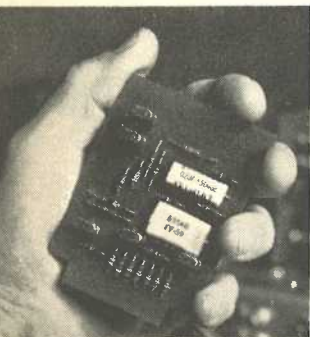
De kunstmatige zenuwcel, die indien gestimuleerd wordt elektrische impulsen levert als een levende cel.
